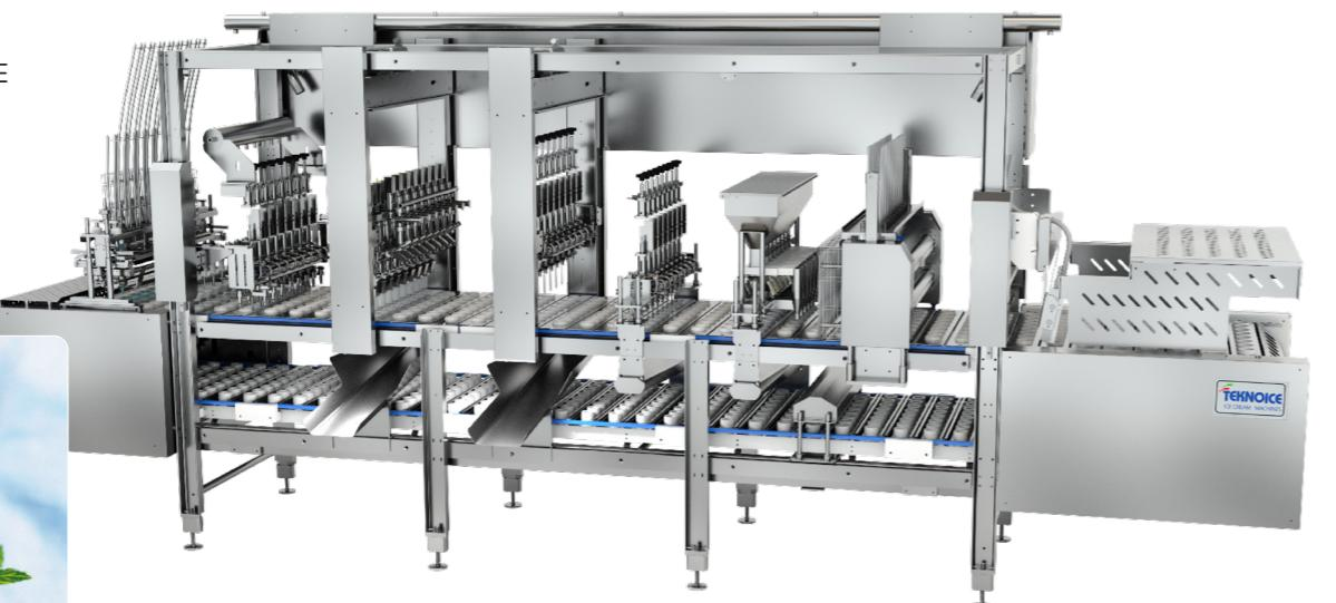
Riempitrice automatica lineare a 2-3 o 4 FILE (per la versione lineare) oppure a 1-2-o 3 file (per la versione rotativa) per il dosaggio ed il riempimento di coppe gelato, coni e vaschette di tipo impilabile, con gelato e/o sorbetto.
