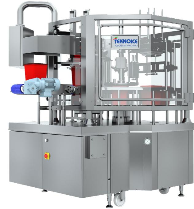
Remplisseuse automatique linéaire à 2, 3 ou 4 RANGÉES (pour la version linéaire) ou à 1, 2 ou 3 rangées (pour la version rotative) pour le dosage et le remplissage de pots de crème glacée, de cônes et de barquettes du type empilable, avec de la crème glacée et/ou du sorbet.
