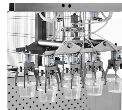
Espulsione con robot a pinze (per VMF-L)
