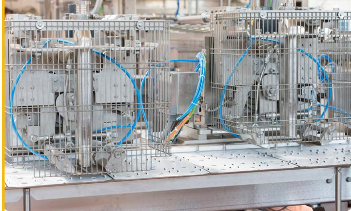
Sistema dinamico di estrusione e taglio gelato con pezzi di frutta, dotato di movimento servo-comandato di inseguimento vassoi per posizionare e tagliare la fetta in modo preciso.
