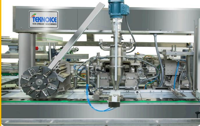
Attrezzatura per la produzione di gelato su stecco di svariate forme e dimensioni, composto da sistema di estrusione, taglio a filo riscaldato.
