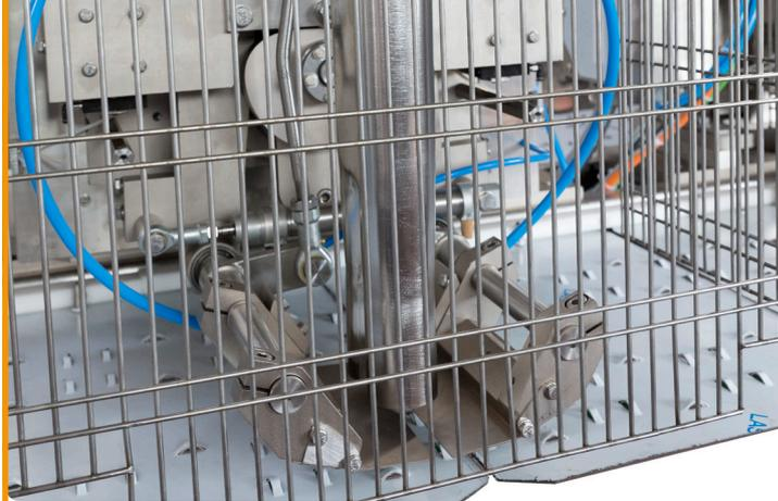
Sistema dinamico di estrusione e taglio gelato con pezzi di frutta, dotato di movimento servo-comandato di inseguimento vassoi per posizionare e tagliare la fetta in modo preciso.
